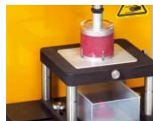
Cellule pour extrusion permettant une extrusion vers l'avant ou vers l'arrière. Idéal pour les garnitures de tartes, les enrobages de gâteaux, etc.
