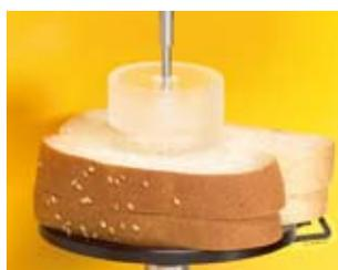
Sonde cylindrique pouvant assurer une compression uniforme sur une surface fixe. Idéal pour la plupart des produits de boulangerie, etc.
