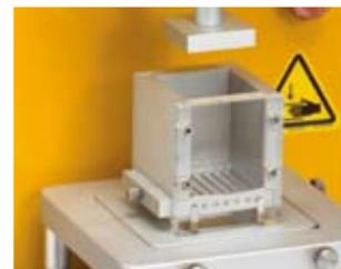
Comprime et extrude les échantillons avec un piston plongeur mobile. Idéal pour les céréales sèches, les fruits et les légumes de petite taille, etc.
