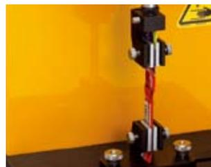
Comprime les échantillons afin de reproduire le mouvement de «déchirure» ou d'étirage. Idéal pour les produits et les emballages.
