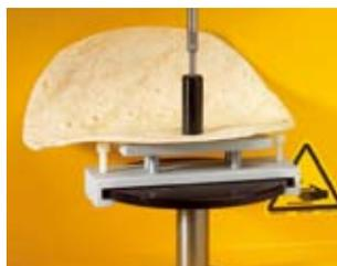
Test de compression par perforation de matériaux solides tels que des tortillas et des films.
