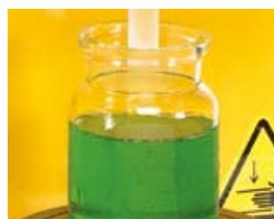
Sonde et récipient à échantillon agréés permettant d'effectuer des tests Bloom sur gélatine.
