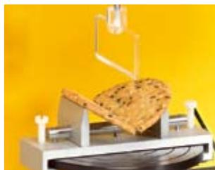
Sonde à bord tranchant pouvant être utilisée pour tester la résistance à la cassure. Idéal pour les cookies, les crackers, etc.
