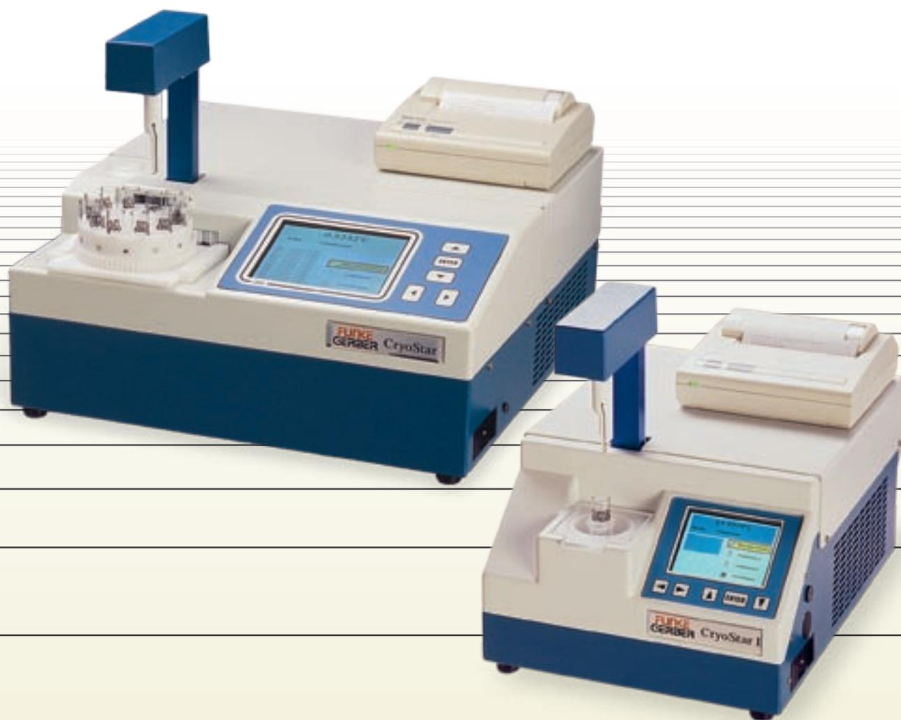
**CryoStar vous permet de mesurer rapidement et de manière fiable le point de congélation du lait** Mesure de référence selon DIN / ISO/ IDF 5764
