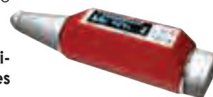
**A partir de la valeur de rebond mesurée, la force de compression du béton peut être calculée automatiquement et affichée sur son écran OLED, de plus les données sont mémorisées et peuvent être transférées via son port USB ( livré en série ) sur un PC externe ou en option sans fil par Bluetooth.**
