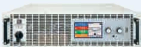
Série DC de charges électroniques à réinjection sur le réseau proposant 10 modèles de 3,5kW jusqu'à 10,5kW. Cette série propose une gamme de tension jusqu'à 1 500V et de courant jusqu'à 510 A selon modèle. Rack 3U 19". Puissance extensible jusqu'à 105kW par mise en parallèle des charges. Affichage graphique tactile, générateur de fonctions intégré pour création de profils. Possibilité avec la série EL 9000B de les coupler avec une alimentation EA pour applications 4 quadrants.
