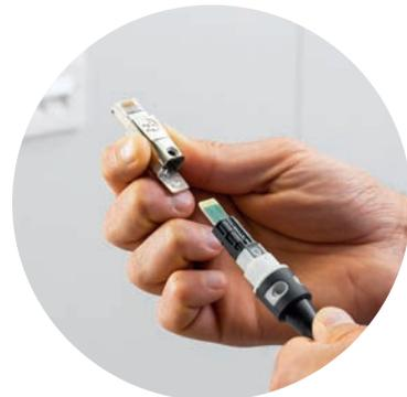
Les contacts RJ45 sur les modules Permanent Link VisiLINQ™ peuvent être remplacés directement sur le terrain par les utilisateurs afin de réduire les dépenses. Le nombre moyen d'insertions réalisables est de 2000, soit 1250 de plus que des cordons RJ45, d'après les normes ISO/TIA.
