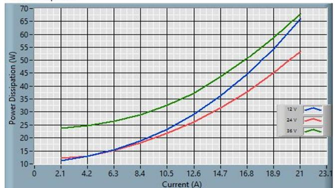
Fig. 14: 24S48.21FXW (ROHS) Power Dissipation
