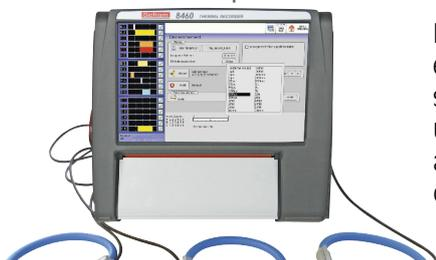
Les mesures sont réalisées en utilisant les entrées tension (directes) de la carte universelle et des pinces accessoires (flexibles ou conventionnelles)
