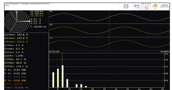
Analyse et enregistrement des harmoniques jusqu'au rang 50
