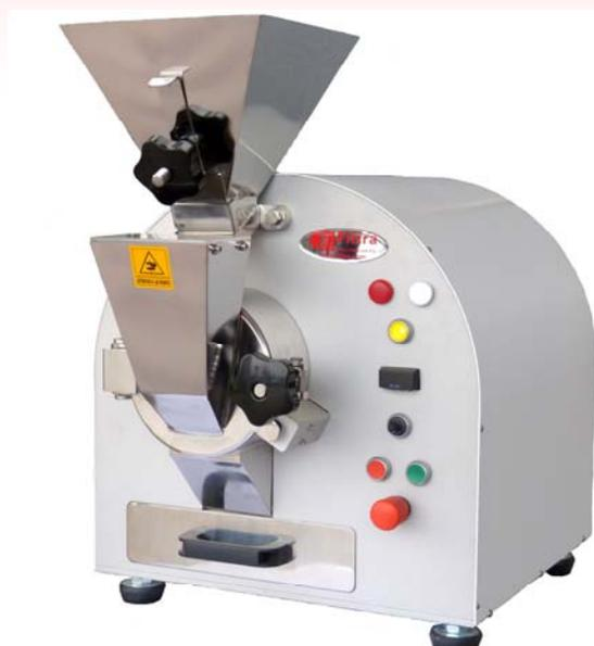
Broyeur à marteaux conçu pour réaliser la mouture d'une grande variété de produits solides : blé, plastiques, résines, minéraux, végétaux, etc. Destiné à des laboratoires de l'industrie alimentaire, chimique, pharmaceutique et céramique.
