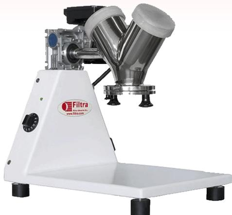
Les mélangeurs en "V" de laboratoire sont utilisés pour l'homogénéisation de produits en poudre. Ils disposent de deux ouvertures de chargement avec couvercles en silicone et d'une ouverture d'évacuation du mélange avec valve de type à tiroir pour faciliter le déchargement. La capacité utile est de 50% du volume total du mélangeur.
