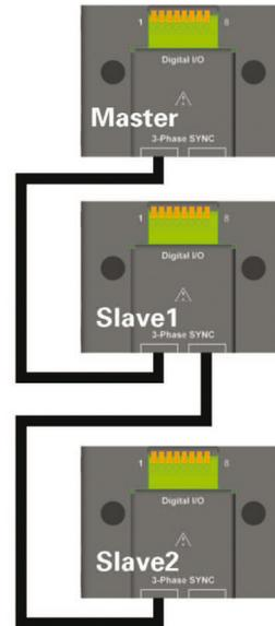
Les adaptateurs TL983P se connectent au connecteur d'E/S numérique à l'arrière de la source AC. Des câbles de communication RJ45 standard connectent chaque adaptateur pour acheminer le signal de synchronisation triphasé du maître vers les unités esclaves.
