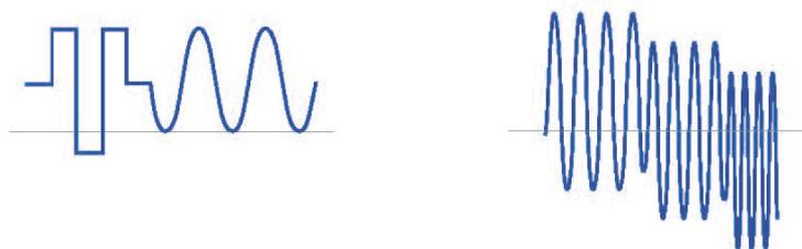
La série BK9830B est capable de générer des formes d'ondes AC + DC. Lorsque vous utilisez le mode impulsion, marche et liste, le signal AC peut être combiné avec une tension continue positive ou négative, ce qui permet aux utilisateurs de créer une large gamme de formes d'onde.
