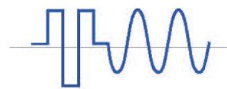
Le mode liste permet de générer des séquences complexes avec un temps, une amplitude, une fréquence et une tension variables. Jusqu'à 100 étapes dans 10 programmes peuvent être sauvegardés et exécutés. Cela permet à l'utilisateur de créer un large éventail de formes d'onde pour simuler les défauts et perturbations du réseau électrique.
