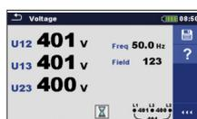
Mesure de tension (triphasé)
