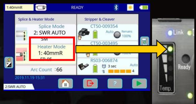
La température de chauffe change selon le mode de soudure
