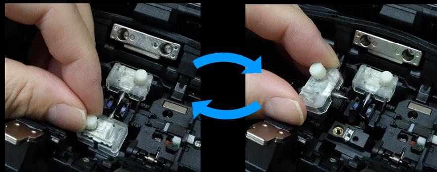
De même, le support transparent des électrodes permet un éclairage plus large des gorges en V. Puisque les mâchoires s'ouvrent du côté opposé à l'éclairage, la zone des mâchoires est intégralement éclairée.
