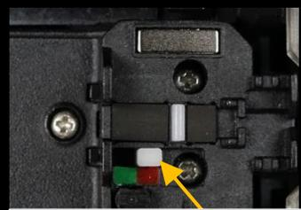
Mécanisme en position « rouge »
