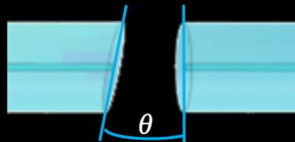
\*Résultat de soudure d'une FO G.652 mesurée selon la méthode cut-back. La perte peut varier en fonction du type de fibre et de ses caractéristiques.
