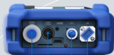
Interface OTDR MM/SM /source lumineuse
