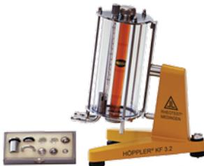
**Viscosimètre suivant Höppler KF3.2**
