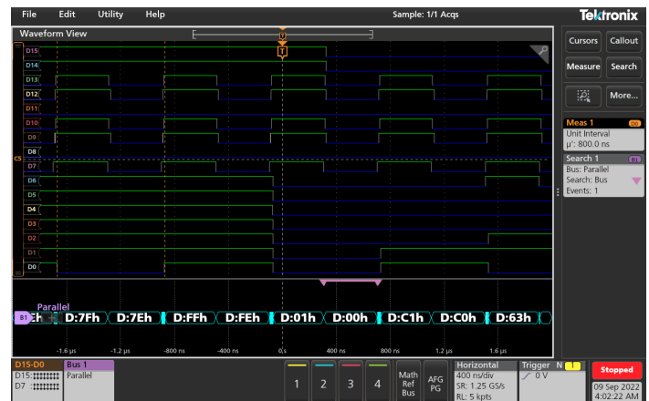
Déclenchement et décodage de voies numériques
