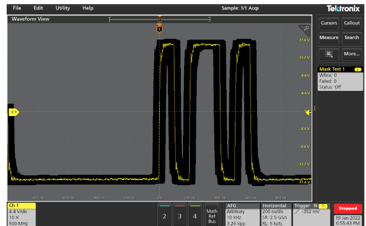
Test de limite de masque basé sur le signal de référence idéal
