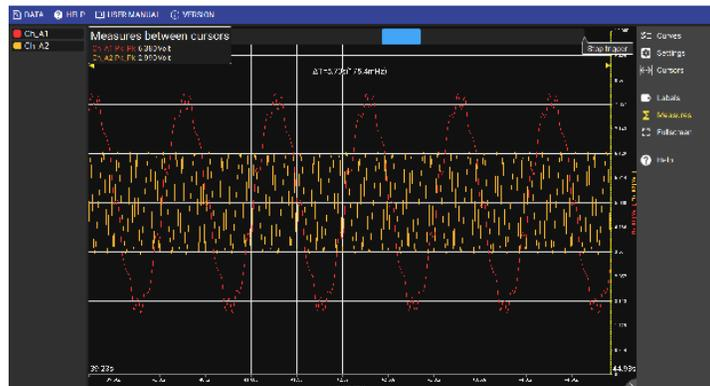
Le logiciel DASpro est un logiciel sans licence qui peut être téléchargé à partir du site sefram.com. Ce logiciel permet aux utilisateurs d'ouvrir et de visualiser les enregistrements des fichiers au format universel MDF4 sauvegardés par le DAS1800. Les fonctions de visualisation des données et d'analyse sont similaires à celles présentes sur le DAS1800, ce qui rend son utilisation facile et intuitive.
