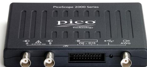
Oscilloscope à signaux mixtes (MSO) à 2+16 canaux
