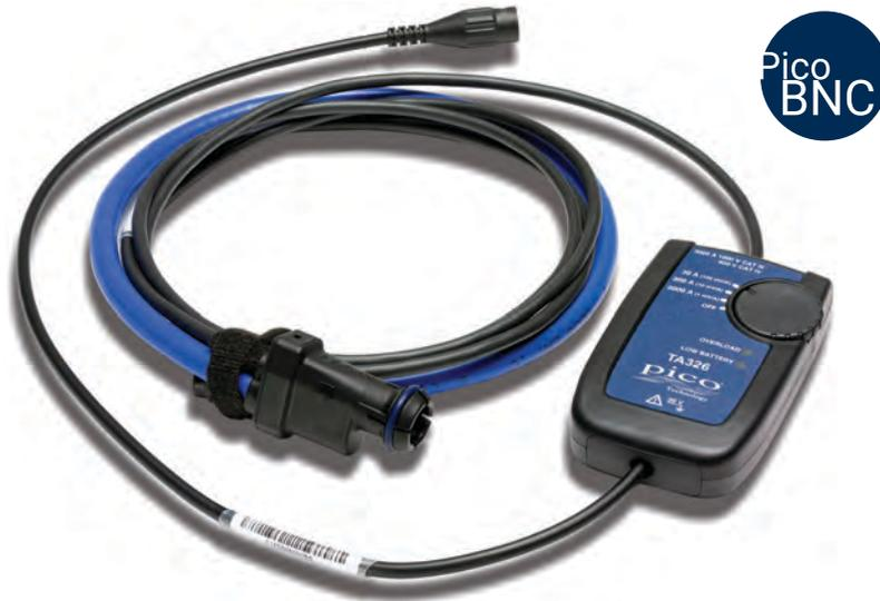
La sonde TA326 est une sonde AC RMS de 30/300/3000 A à plage commutée avec une bande passante de 10 à 20 kHz, évaluée à 1000 V CAT III sur les conducteurs non isolés. La durée de vie de la batterie est de 2000 heures.
