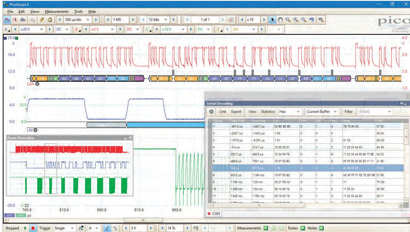
**Le Format de graphique** indique les données décodées (au format hexadécimal, binaire, décimal ou ASCII) dans un format de diagramme temporel, sous la forme d'onde sur un axe temporel commun, avec les trames d'erreur marquées en rouge.
