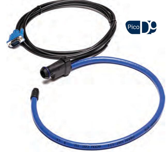
La TA368 est une sonde RMS AC de 2000 A à bande passante de 10 Hz à 20 kHz, adaptée à 1000 V CAT III et 600 V CAT IV sur des conducteurs non isolés. Elle est équipée d'une bobine de capteur flexible vous permettant de mesurer des courants sur des conducteurs difficiles d'accès.
