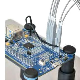
*Pour les collecteurs avec des signaux situés ensemble et pas assez de terres. Un connecteur de terre peut être utilisé pour connecter à une broche de terre à distance sur le dispositif testé.*
