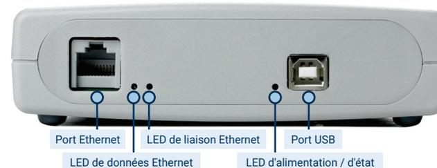
Port Ethernet    LED de liaison Ethernet    Port USB
