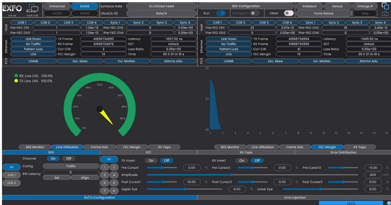
Figure 4. Test du TEB FEC avant/après, distribution de l'erreur de symbole et marge FEC.
