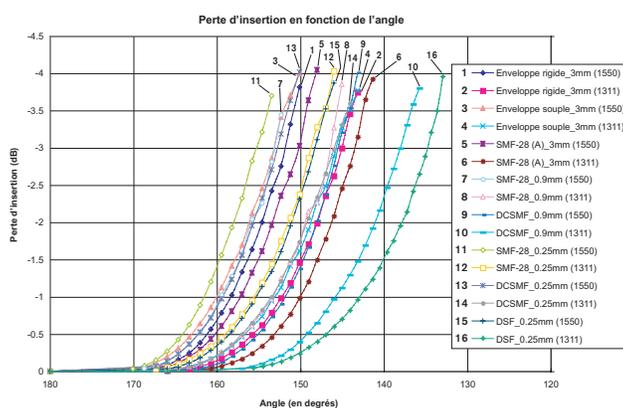
Figure 1. En mesurant continuellement la perte, le LFD-300B peut arrêter de plier la fibre lorsque suffisamment de lumière est éjectée, minimisant ainsi la perte occasionnée.
