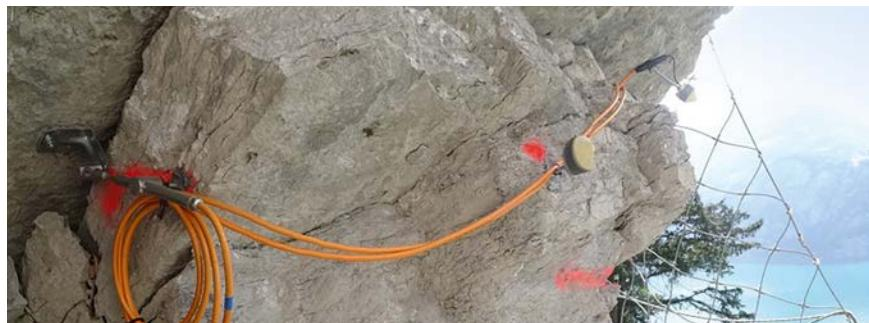
La surveillance des crevasses est facile! AarteLink® surveille également facilement et efficacement les chantiers en zones dangereuses. Les messages d'alarme peuvent être envoyés directement à la radio du site de construction. En plus des diverses fonctions de base pour la détection des risques naturels, la combinaison Telejoint et
