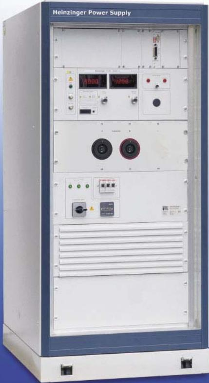
→ Präzisions-Hochleistungsnetzgeräte der Heinzinger PHN- und PHNhp-Serie bieten als **doppelstabilisierte, linear geregelte Hochspannungsnetzgeräte** eine präzise geregelte DC-Spannung bei geringster Restwelligkeit. Sowohl durch den konstruktiven Aufbau als auch durch die elektrischen Eigenschaften erfüllen die Geräte höchste Ansprüche. Mit der PHN-Serie lassen sich Genauigkeiten <0,01%, mit den PHNhp-Typen <0,001% realisieren.
