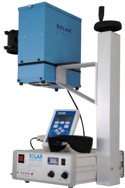
Équipements Scientifiques vous recommande le simulateur solaire 16S SOLAR LIGHT pour des applications industrielles ou de laboratoire nécessitant une source lumineuse intense et très stable. Deux types de filtres sont disponibles : les **filtres Air Mass** reproduisant précisément le spectre solaire terrestre et les **filtres UV** (UVA ou UVA+UVB) pour obtenir un maximum de rayonnements UV responsables du vieillissement.
