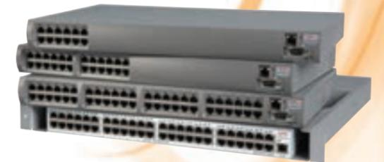
La série PowerDsine 6500 est entièrement conforme à la norme IEEE 802.3af, qui définit PoE, en fournissant un minimum de 15,4 W par chaque port. Avec le support complet de SNMPv3, la série 6500 propose une gestion évoluée de réseau de grande sécurité, en assurant la maîtrise du Midspan et des terminaux de données qui lui sont connectés.
