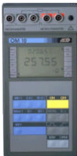
Le microhmmètre OM 10 est destiné à mesurer en 4 fils des résistances à partir de faibles valeurs (10  $\mu$  de résolution) jusqu'à 50 k avec grande précision. Il peut également mesurer des tensions continues et alternatives et la température ambiante.
