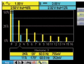
L'analyse des harmoniques s'effectue sur 2 voies jusqu'au rang 31, avec une fréquence du fondamental comprise entre 40 et 450 Hz. Simultanément, le **HANDSCOPE** mesure les valeurs de la tension VRMS totale, du THD et
