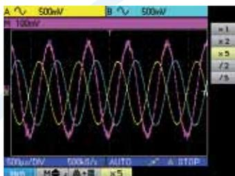
Sur chacune des deux voies isolées, il est possible de sélectionner et d'afficher des mesures automatiques parmi les 19 choix proposés (Amplitude, Temps ou Phase). En complément des fonctions MATH permettent d'élaborer la représentation temporelle d'un signal dérivé des voies par une opération mathématique (+, -, x, / inversion) avec une mise à l'échelle automatique.
