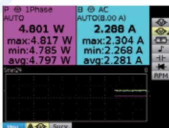
Comme pour les trois modes instruments, un simple appui sur la touche dédié donne accès au mode multimètre qui permet des mesures de tension et de courants AC, DC et AC+DC, de résistance, de continuité, capacités, de fréquence, de puissances (combinaison de deux voies de mesure) ainsi que de température (thermocouple K ou sonde infrarouge), de vitesse de rotation moteur (tachymètre optique) et le test de diode et de composants.
