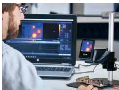
Connectez-vous par USB à un ordinateur pour analyser les données dans FLIR Tools+
