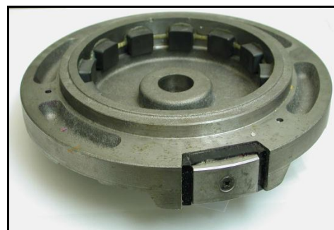
Collage d'aimants sur un volant avec 6-625-Gel-Rev. A
