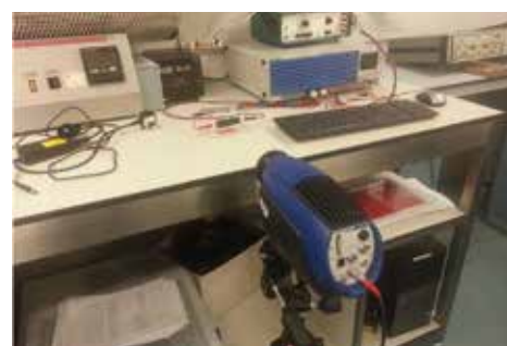
Caméra FLIR SC5000 en action, pointée vers une batterie 18650
